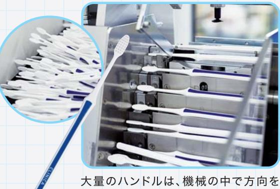
大量のハンドルは、機械の中で方向を揃えて整列。自動的に次の植毛ラインへ運ばれていきます。
