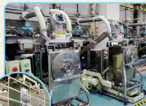
コンピュータ制御された大型の自動計量装置で、ハミガキ剤の目的に応じ、それぞれの原料を適切に計量します。
