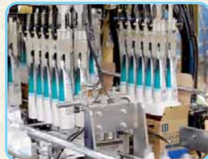
10本ずつまとめて、ロボットアームで箱詰めします。スピーディーに封入されて、出荷準備完了!
