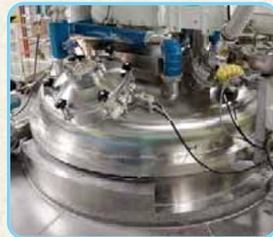
直径約2mの釜で原料を配合。気泡を抜くために真空状態にして、混合と練上げを行います。一度に6t(約4万本分)のハミガキ剤を作ることができます。
